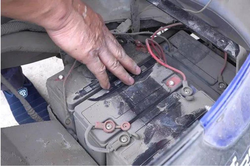
部分车主擅自改装电动自行车的动力电源，破坏整车电气线路的安全性能，充电时容易引发车辆电气线路过载、短路等故障，引起火灾事故的几率相对增大。
